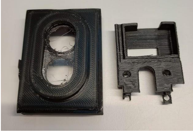
(Kuva 8. Mahdollinen pienempi kotelointi, joka sisältää akryylisen värikamerasuojan ja TPU-95a materiaalista tulostetun vesitiivisteen. Tyylikkäämpi ja symmetrinen ulkonäkö)
