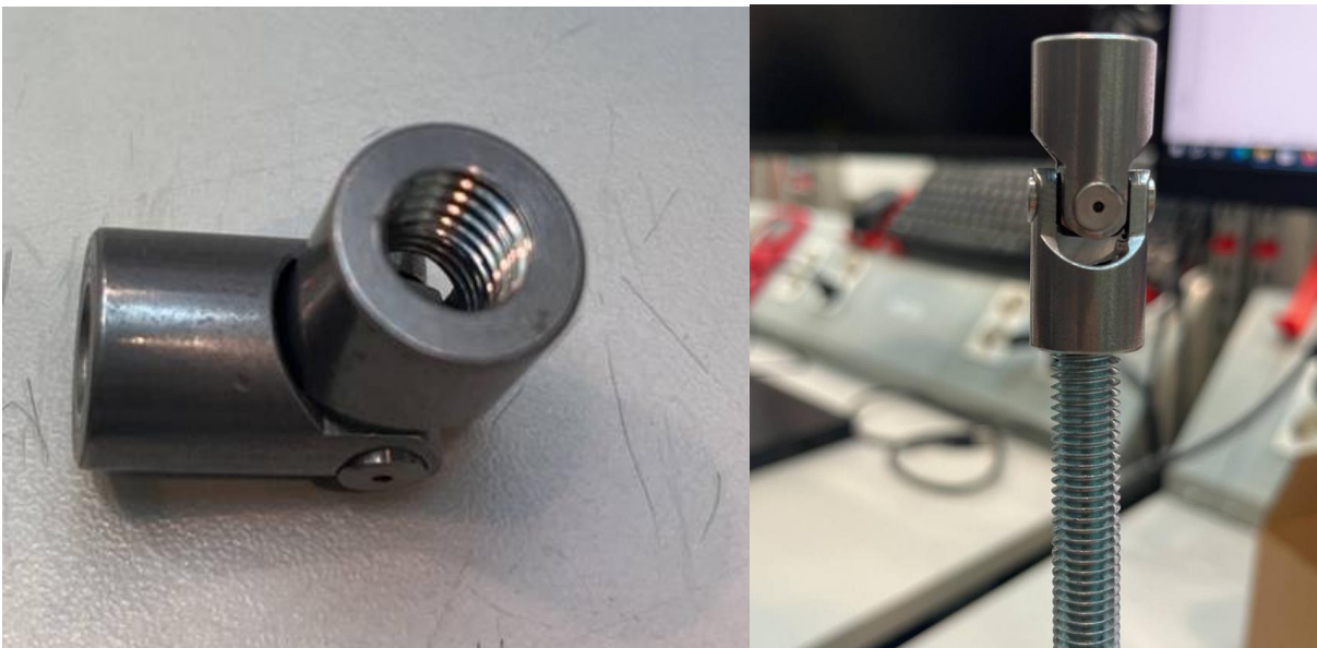
Kuva 13: U-jointiin ajetut urat ja se kiinnitettynä kierretankoon.
