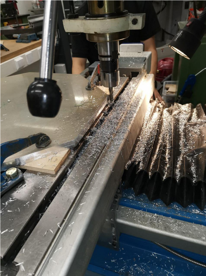
Kuva 18. Alumiinilevyjen reunojen jysyntä tasaiseksi.
