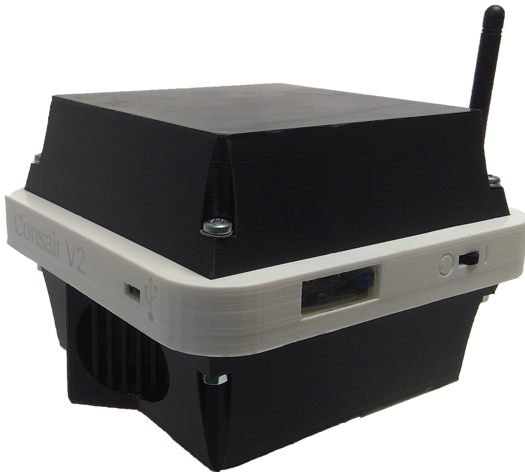
Kuva 9: V2 -kuori. Koostuu valkoisesta keskilaudasta ja mustista kuoren puolikkaista. Ripustusrenkas sijaitsee laitteen toisella puolella
