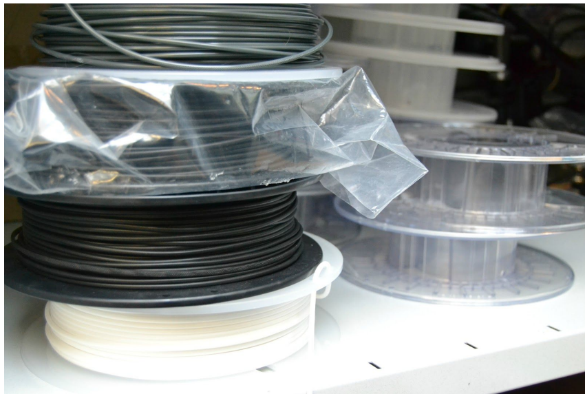
Kuva 6. Rannekkeen 3D-tulostusmateriaaliksi valikoitui PLA-flex
